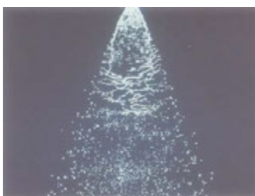
شکل ۴- اسپری درشت قطره (coarse)
